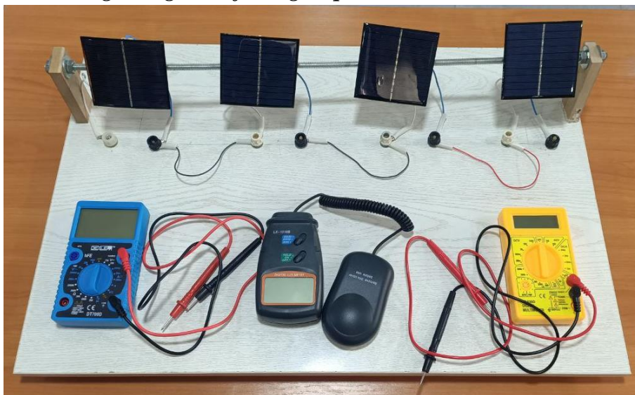
2-rasm. Pedagogik ta‘lim klasteri sharoitida fotoelementning ishlash prinsipini o‘rganishga mo‘ljallangan qurilma namunasi
