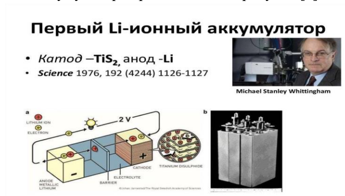
Рис.2. Конструкция первого литий ионного аккумулятора
