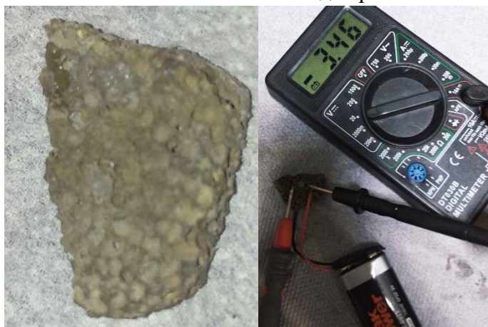
Рис.2. Тонкое серебряное покрытие методом реакции серебряного зеркала на поверхности пемзы создало проводящий слой
